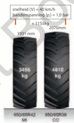
Figuur 5 Draagkracht bij verschillende velgdiameter - Bron: DLG
