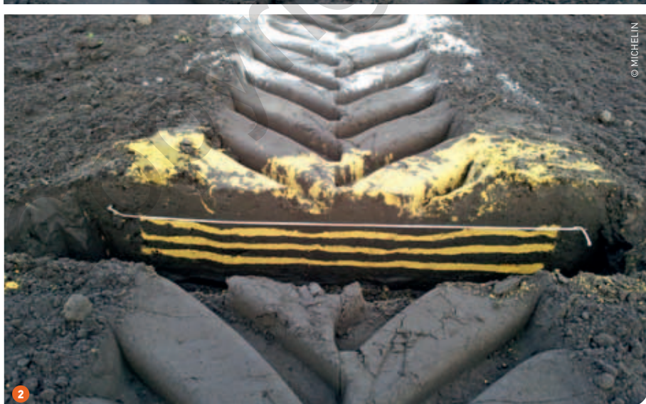
Vergelijking van 1 de grondverdichting onder belasting met klassieke technologie (600/65 R 38, 1,2 bar) en 2 grondverdichting onder belasting met ultraflextechnologie (VF650/60 R 38, 0,8 bar). De bodemlagen zijn bij gebruik van ultraflexbanden 33% minder samengedrukt.
