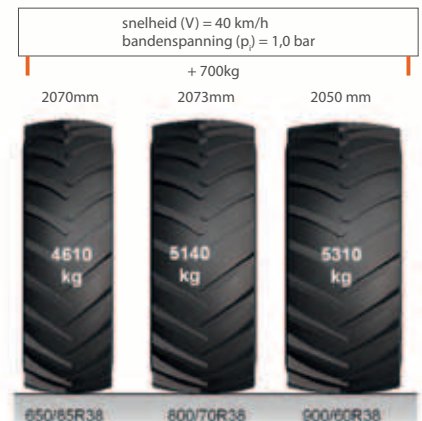
Figuur 6 Draagkracht bij verschillende bandbreedtes - Bron: DLG
